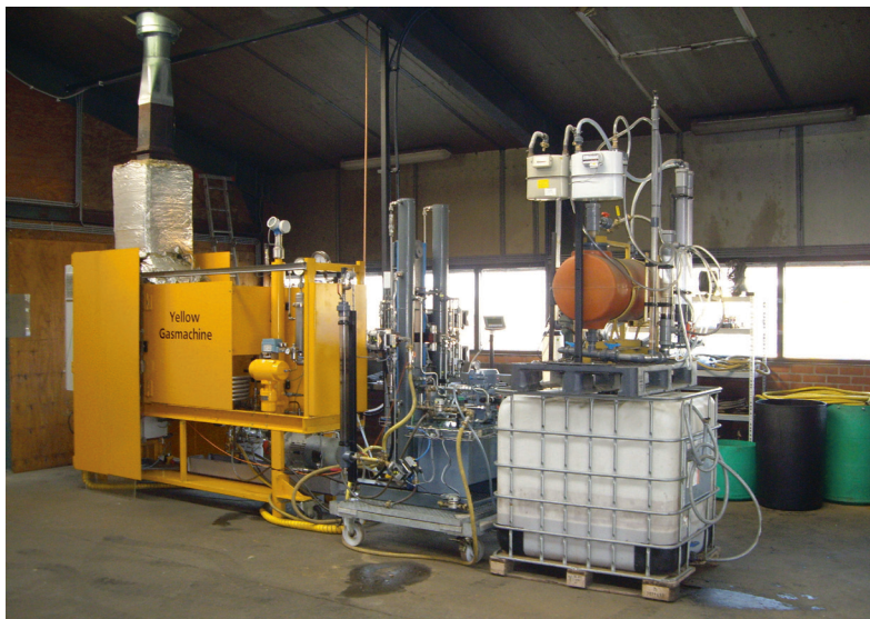
Foto prototype unit voor superkritische vergassing van drijfmest - Foto: SPARQLE International BV
